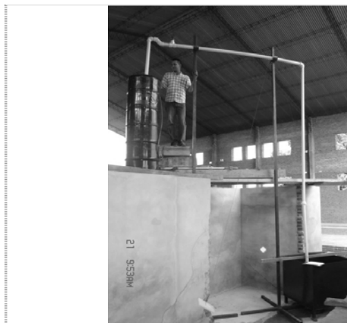
Foto 5. Detalle completo del sifón de 3" estudiado en el laboratorio
