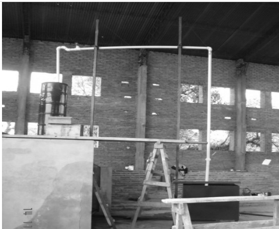
Foto 3. Detalle completo del sifón de 2" estudiado en el laboratorio.
