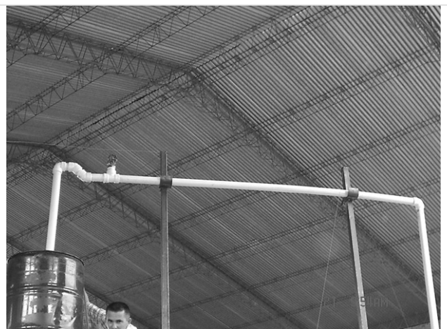
Foto 6. Detalle de la succión del sifón de 3" estudiado en el laboratorio
