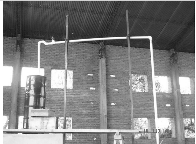
Foto 4. Detalle de la succión del sifón de 2" estudiado en el laboratorio.
